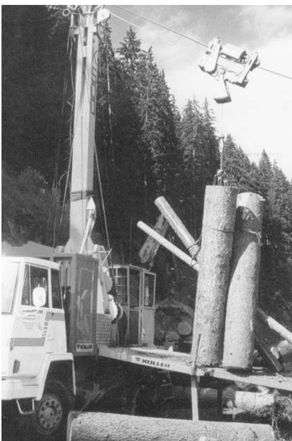
Мобилна мачтова въжена линия, тип "Koller", монтирана върху платформата на автомобил
