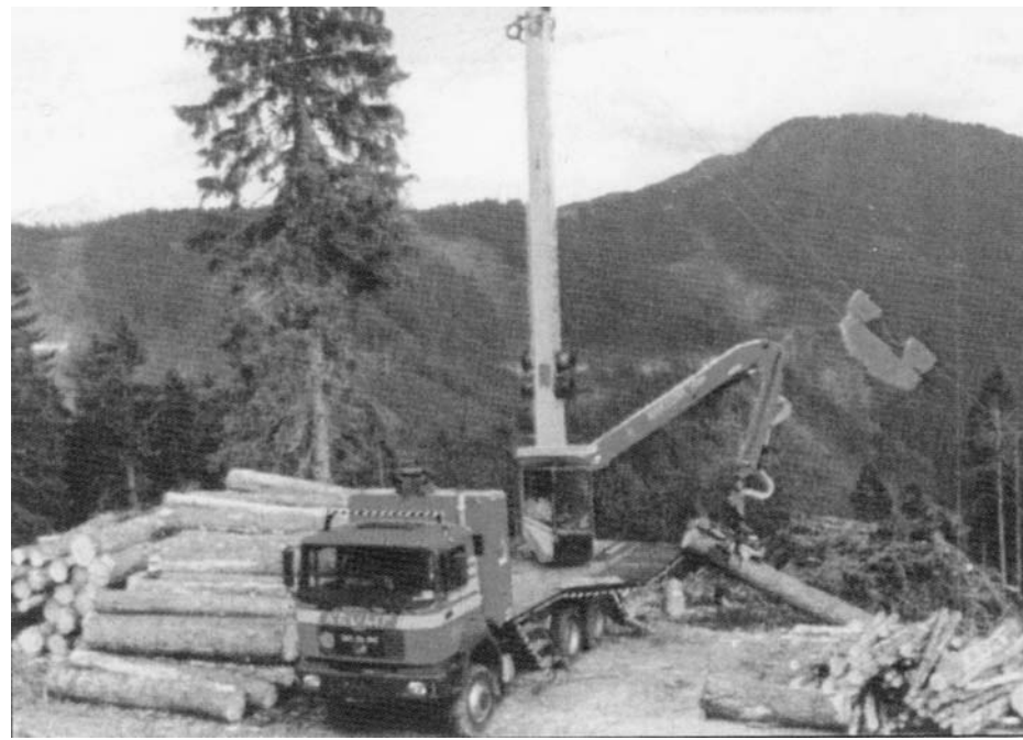
Мобилна мачтова въжена линия, снабдена с хидравличен кран за сортиране и рампиране на извозните материали
